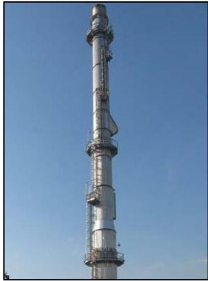
ภาพที่ 2.2-1 หน่วยเผาทำลายก๊าซและของเหลวที่เหลือจากการผลิต (TOX) ในความรับผิดชอบของ HPPO
